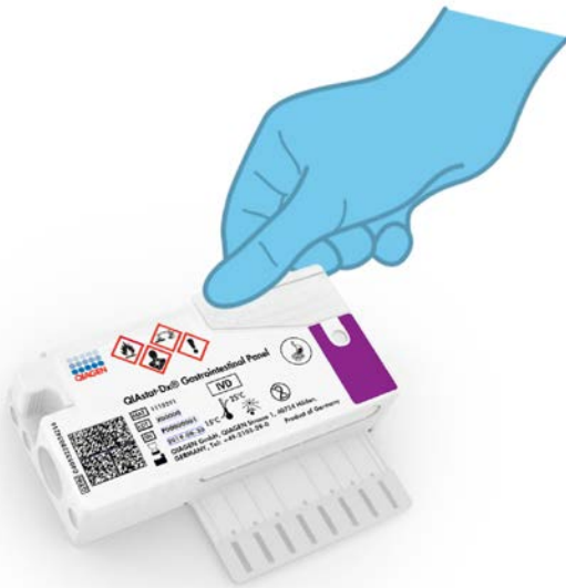
Abbildung 10: Schließen des Deckels der Hauptöffnung
