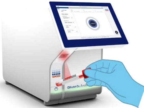
Abbildung 12: Scannen des Proben-ID-Barcodes
