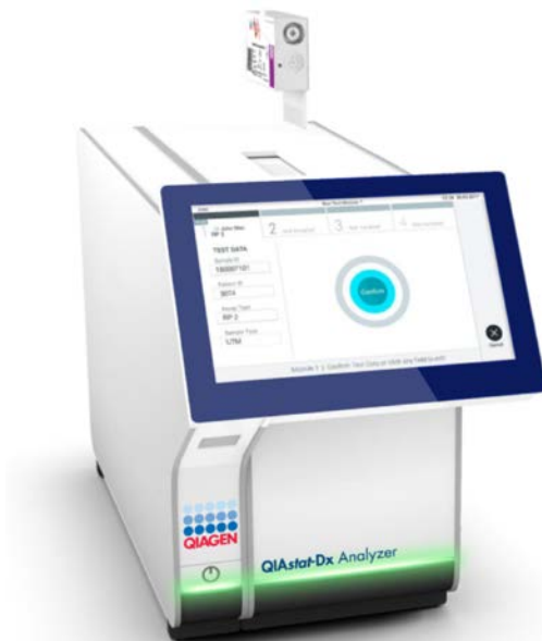
Abbildung 15: Einlegen der QIAstat-Dx Gastrointestinal Panel Cartridge in den QIAstat-Dx Analyzer 1.0.
