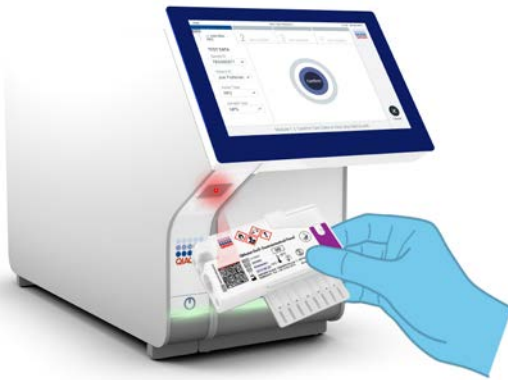
Abbildung 13: Scannen des Barcodes der QIAstat-Dx Gastrointestinal Panel Cartridge
