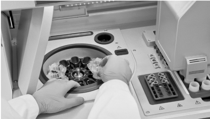
รูปที่ 21: การโหลดเครื่องหมุนเหวี่ยงบน QIAcube Connect MDx โหลดโรเตอร์อะแดปเตอร์ที่ประกอบแล้วเข้ากับถังหมุนเหวี่ยง
