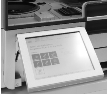
รูปที่ 16: หน้าจอสัมผัสแบบดึงออกของ QIAcube Connect MDx
