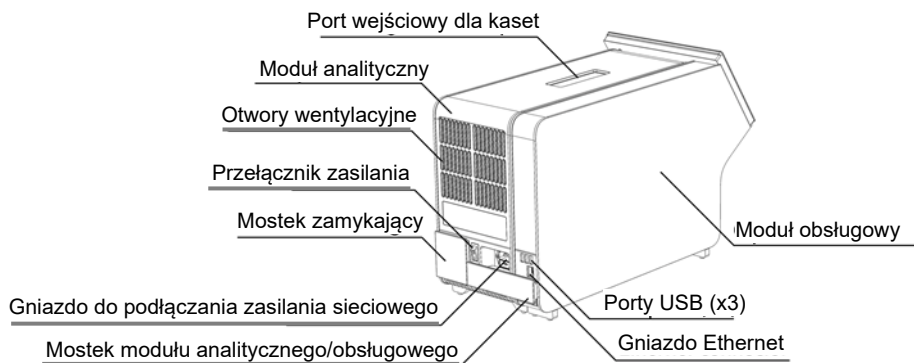
Ryc. 2. Widok analizatora QIAstat-Dx Analyzer 1.0 z tyłu. Moduł obsługowy znajduje się z prawej strony, a moduł analityczny z lewej.
