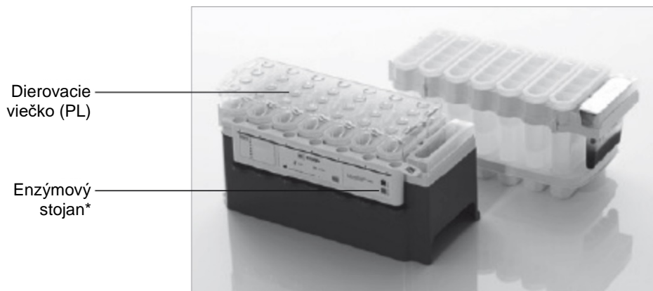
Obrázok 3. Jednoduché nastavenie pracovného stola s reagenčnými kazetami (RC). * Súprava QIASymphony DSP HPV Media Kit neobsahuje alebo si nevyžaduje enzýmový stojan.
