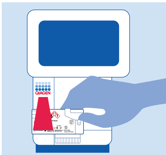
12 pav. „QIAstat-Dx Meningitis/Encephalitis Panel Cartridge“ kasetės brūkšninio kodo nuskaitymas.
