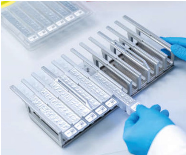
Figure 3. Portoir de cartouches de réactif. La flèche figurant sur le support de cartouches indique dans quel sens les cartouches de réactif (RCB) doivent être chargées.
