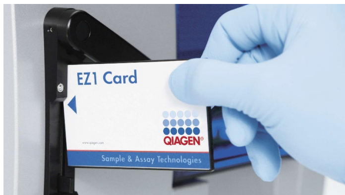
Figure 6. Configuration facile des protocoles avec les cartes EZ1 DSP. Insertion d'une carte EZ1, préprogrammée avec le protocole, dans l'appareil EZ1.
