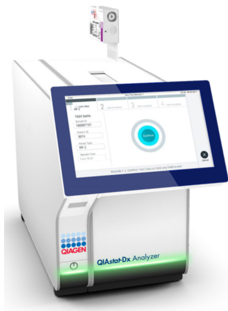
Рисунок 13. Вставка картридж QIAstat-Dx Gastrointestinal Panel 2 Cartridge в анализатор QIAstat-Dx Analyzer 1.0 или QIAstat-Dx Analyzer 2.0.
