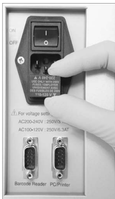
Pareizā drošinātāja izvēle darbam ar 100–120 V barošanas avotu
