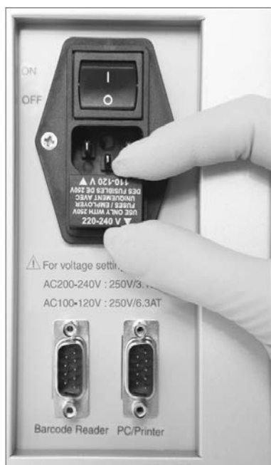
Pareizā drošinātāja izvēle darbam ar 200–240 V barošanas avotu
