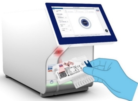
Ryc. 12. Skanowanie kodu kreskowego kasetki QIAstat-Dx Respiratory SARS-CoV-2 Panel Cartridge.
