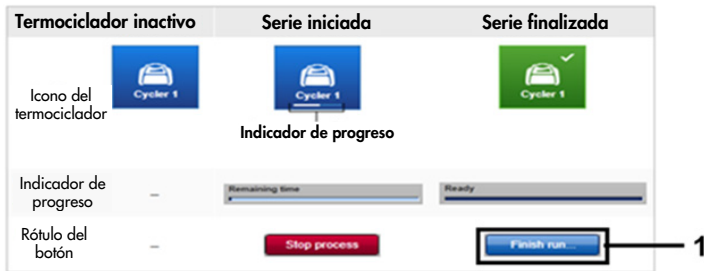
Figura 14. Finalización de una serie. 1 = “Finish run” (Finalizar serie).
