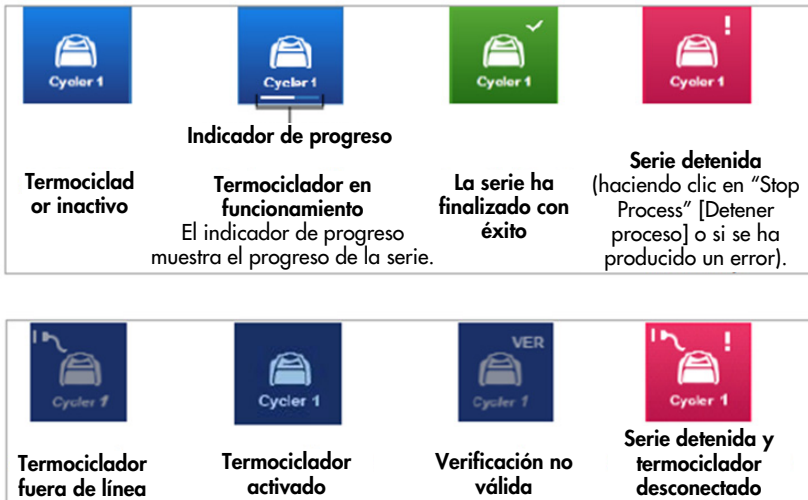
Figura 13. Iconos de Cycler (Termociclador) Rotor-Gene Q MDx 5plex HRM que pueden mostrarse.
