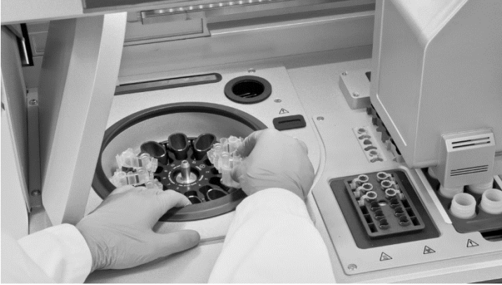
Şekil 21: QIAcube Connect MDx'te santrifüjü yükleme. Kurulu rotor adaptörlerini santrifüj kovaları içine yükleyin.
