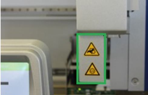
† Positie van het label voor gevaar voor verbijzeling en waarschuwingslabel UV-licht (SP/AS).
