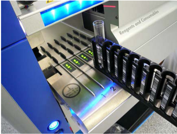
De buisendrager in het juiste slot schuiven.
