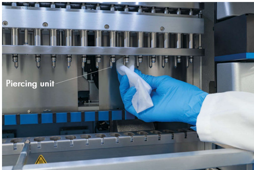
Figura 174. Limpando a unidade de perfuração do EZ2.
