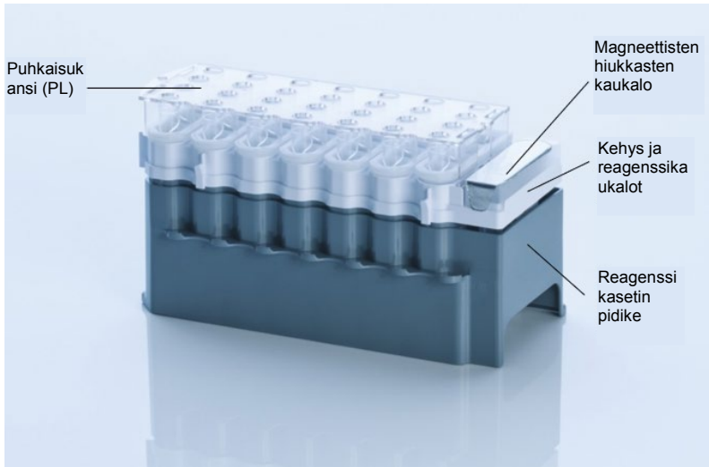
Kuva 2. QIA Symphony-reagenssikasetti. Reagenssikasetti sisältää kaikki protokolla-ajossa tarvittavat reagenssit.
