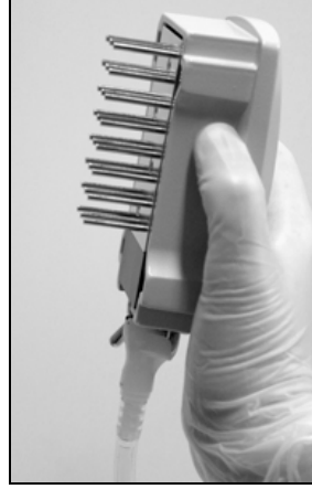
Şekil 3: Resimde 90°den fazla dikey açıyla kaldırılan vakum aleti görülüyor.
