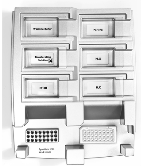
Şekil 2: Vakum iş istasyonu üzerindeki PyroMark Q24 plakası ve PCR plakasının (ya da şeritlerin) yerleştirilmesi.
