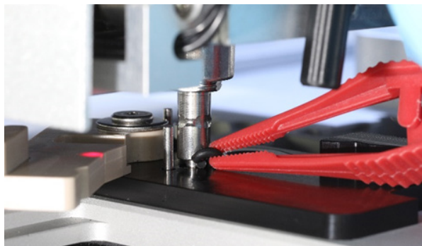
Otvorte sivú páku a odstráňte O-kružok pomocou pinzety.
