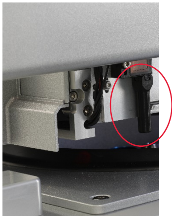
Čierny kolimátor zväzku (pozri červený krúžok) ultrazvukového senzora.
