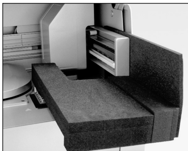
Beschermingsschuim tussen centrifuge en robotarm.
