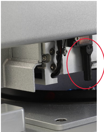
Zwarte collimator (rode cirkel) van de ultrasoonsensor.
