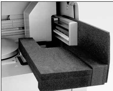
Beschermingsschuim om de robotarm
