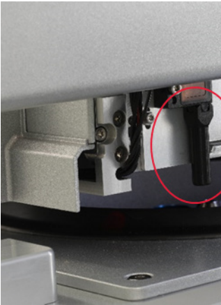
Zwarte collimator (rode cirkel) van de ultrasoonsensor.
