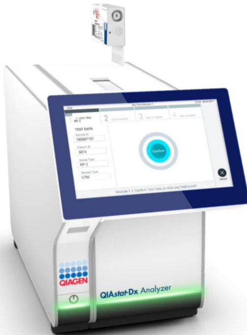
ภาพที่ 28 การใส่ QIAstat-Dx Respiratory SARS-CoV-2 Panel Cartridge ลงใน QIAstat-Dx Analyzer 1.0
