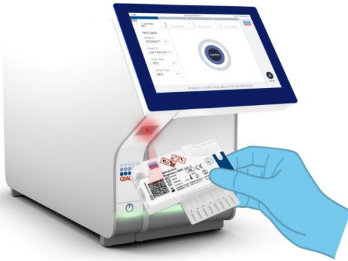
ภาพที่ 25 การสแกนบาร์โค้ด QIAstat-Dx Respiratory SARS-CoV-2 Panel Cartridge
