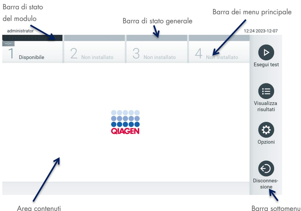
Figura 42. Schermata principale del touchscreen del QIAstat-Dx Analyzer 2.0.
