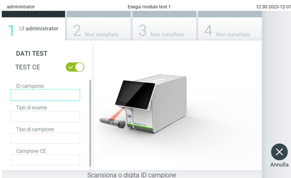
Figura 92. Attivazione del pulsante di commutazione EC Test (Test CE) per abilitare un test CE.
