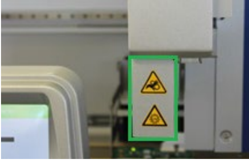
挤压危险警告标签和紫外光警告标签位置 (SP/AS)。
