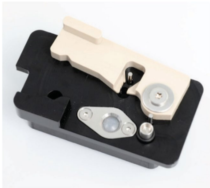
装有新O形环的O形环工具。
