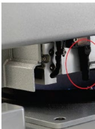
超声传感器的黑色光束准直器（见红圈）。
