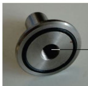
转子螺母的内螺纹。
