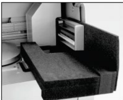
离心机和机械臂之间的防护泡沫。
