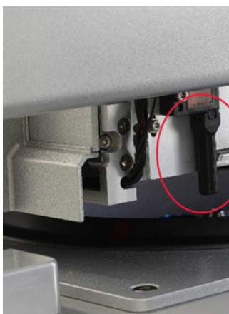
Svart strålekollimator (se rød sirkel) på ultralydsensoren.
