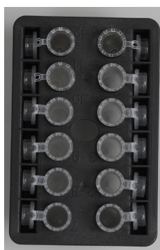
Lokk på prøverør må være godt festet i sporene i kanten av risterstativet
