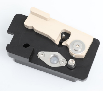
O-ringverktøy med klargjort, ny O-ring.
