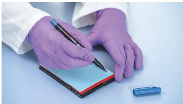
8. Per il trasporto della piastra Nanoplate allo strumento QIAcuityDx, la piastra deve essere tenuta sui bordi laterali o sul vassoio in posizione orizzontale. Assicurarsi che il trasporto della piastra al QIAcuityDx avvenga senza scosse o rotazioni della piastra per garantire che la miscela di reazione si trovi sul fondo del pozzetto di ingresso.
