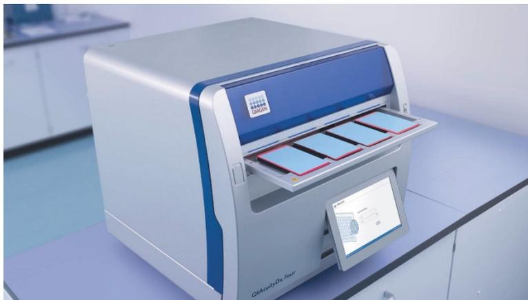
Il cassetto di QIAcuityDx è dotato di alloggiamenti predisposti per supportare il corretto caricamento delle nanopiastrine. Se si carica una nanopiastra con un orientamento errato, il lettore di codici a barre interno non rileverà la nanopiastra caricata e il ciclo non viene eseguito. Prima di chiudere il cassetto, accertarsi che le nanopiastrine siano state caricate correttamente nello slot del cassetto e che siano in posizione orizzontale all'interno del cassetto.
