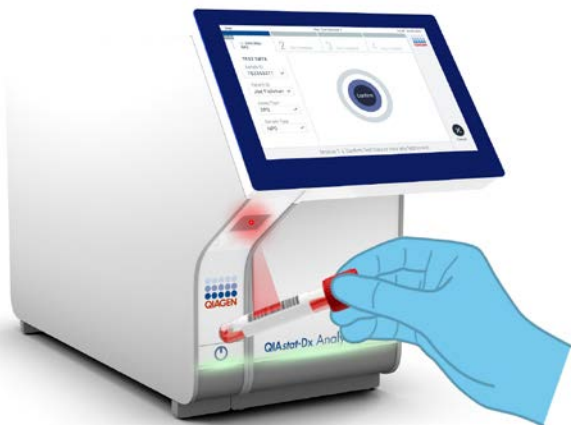
Slika 12. Očitavanje crtičnog koda ID-ja uzorka.
