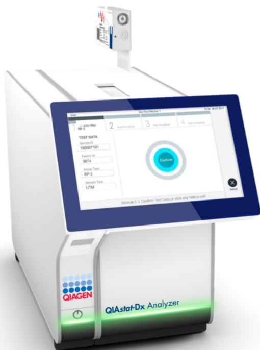
28. ábra: A QIAstat-Dx Respiratory SARS-CoV-2 Panel Cartridge behelyezése a QIAstat-Dx Analyzer 1.0 készülékbe.
