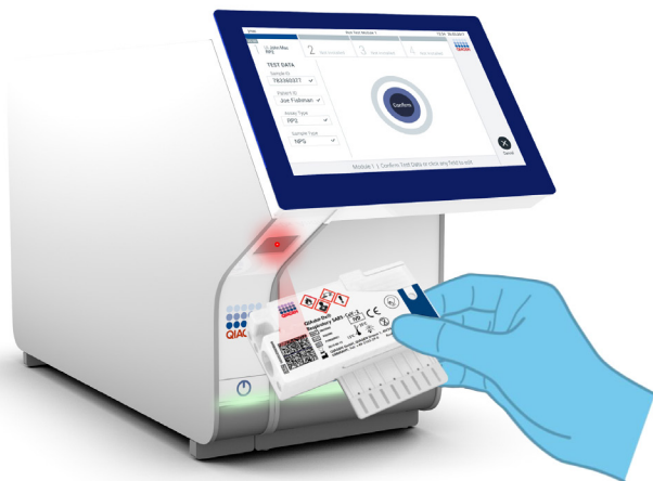
12. ábra: A QIAstat-Dx Respiratory SARS-CoV-2 Panel Cartridge vonalkódjának beszkennelése.
