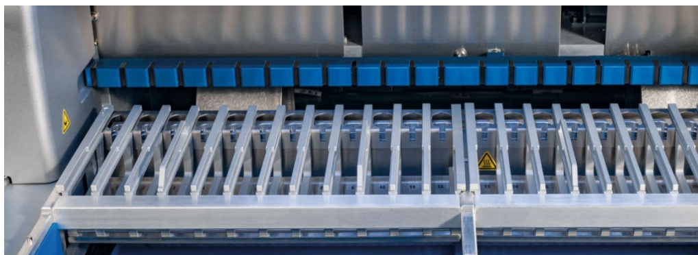
图 12. 仪器内的可拆卸试剂盒架。
