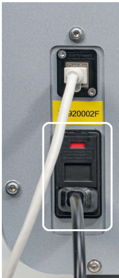
图 7.电源线接口位置（白框圈出部分）。
