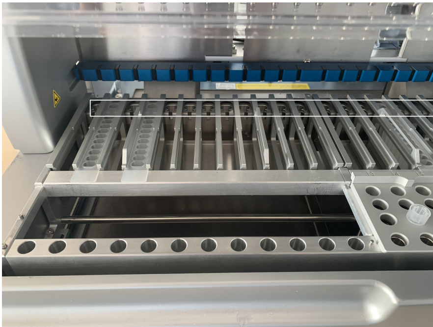
图 17.试剂盒架中的加热位置（白框圈出部分）。
