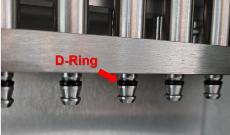
图 177.带醒目标示的 D 形环的吸头适配器。
