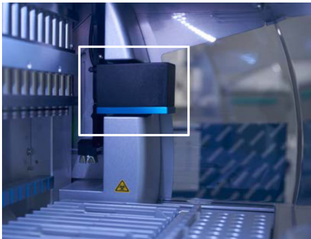
图 20.摄像头模块（白框圈出部分）。
