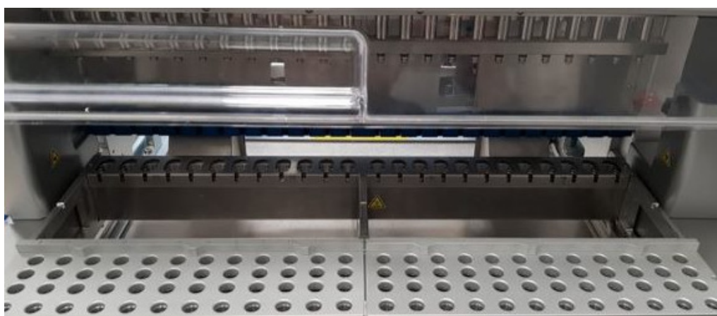
图 15. 仪器内的吸头架。
