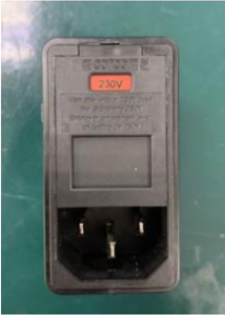
图 8.带 230 V 标志的替代型号电源接口。
