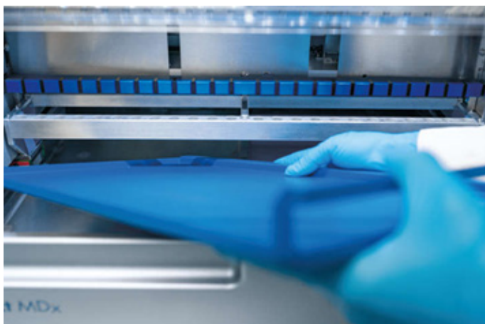
图 176-B. 安装底部集液盘的左侧。
