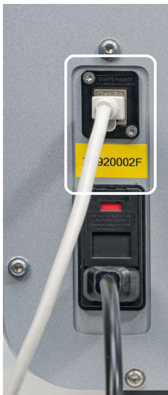
图 6.RJ-45 端口位置（白框圈出部分）。
