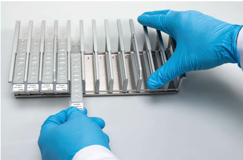
Figure 11. Portoir à cartouches contenant quelques cartouches insérées.
