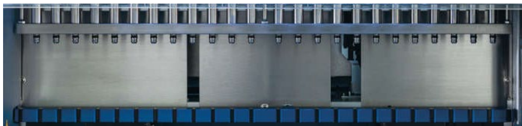
Figure 10. Tête du pipetteur de l'instrument EZ2.
