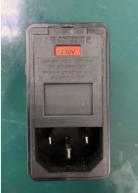
Figure 8. Autre option de prise du cordon d'alimentation indiquant 230 V.
