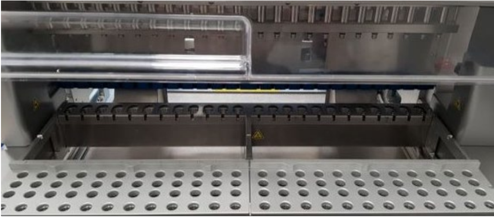
Figure 15. Portoir à embouts dans l'instrument.
