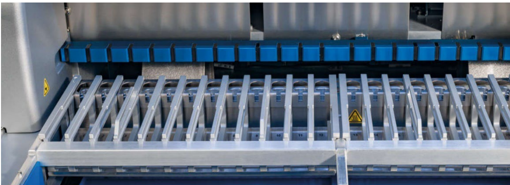
Figure 12. Portoir à cartouches amovible dans l'instrument.
