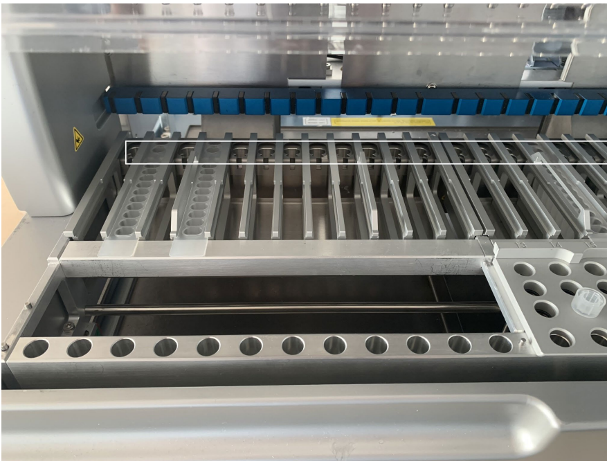
Figure 17. Positions chauffables dans le portoir à cartouches (mises en évidence par un cadre blanc).
