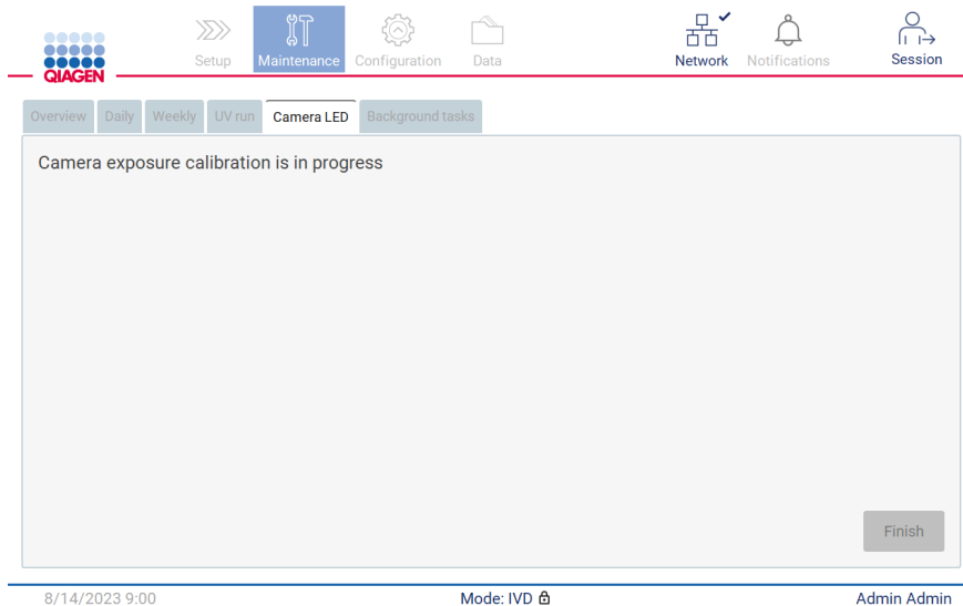
Figure 30. Message d'étalonnage de l'exposition de l'appareil photo en cours.
