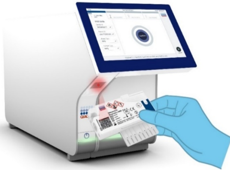
12. attēls. QIAstat-Dx Respiratory SARS-CoV-2 Panel Cartridge svītrkoda skenēšana.
