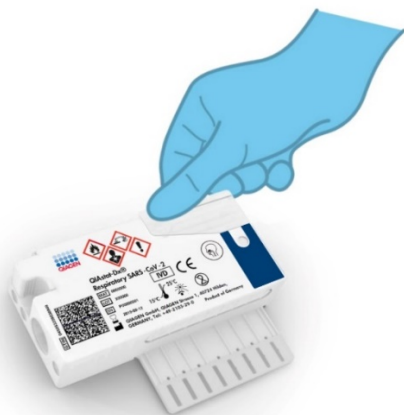
42. attēls. Galvenās atveres parauga nodalījuma vāka aizvēršana.
