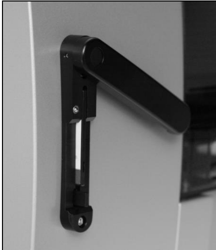
Abbildung 10. Die EZ1 Karte muss vollständig in den Kartenschlitz eingeführt werden.
