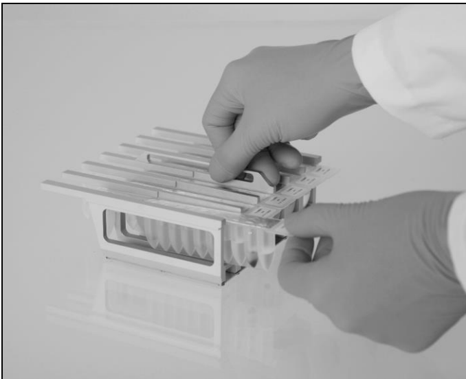
Abbildung 11. Einfache Vorbereitung des Geräts durch Verwendung der Reagenzienkartuschen (RCB). A Eine verschlossene, vorgefüllte Reagenzienkartusche (RCB). B Beladen des Kartuschenhalters mit den Reagenzienkartuschen (RCB). Der Kartuschenhalter ist mit einem Pfeil markiert, um die Richtung anzuzeigen, in der die Reagenzienkartuschen (RCB) in den Halter geschoben werden.
