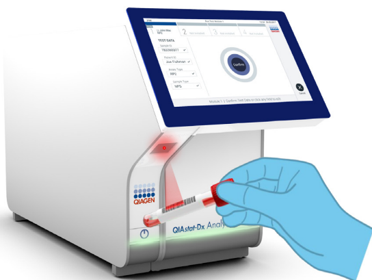
Obrázek 24. Skenování čárového kódu s ID alikvotu.
