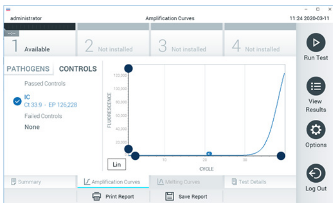
Obrázek 32. Obrazovka Amplification Curves (Amplifikační křivky) (záložka CONTROLS (Kontroly)).
