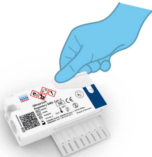
Obrázek 22. Zavření víčka na alikvot v hlavním portu.
