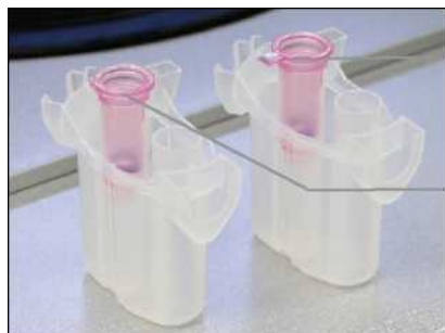
Сравнение правильно и неправильно снятых крышек колонок.
