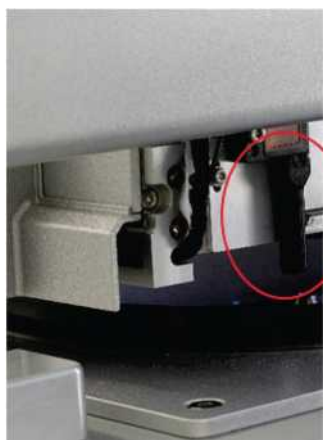
Коллиматор черного луча (красный кружок) ультразвукового датчика.
