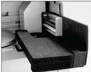
Между центрифугой и манипулятором вставлен пенопластовый протектор.
