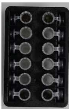
Крышки пробирок с образцами должны быть надежно вставлены в пазы на краю штатива шейкера.
