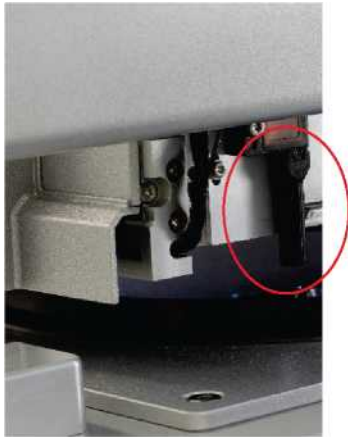
Коллиматор черного луча (красный кружок) ультразвукового датчика.
