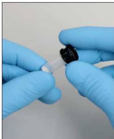
Установка переходного кольца спин-колонки.
