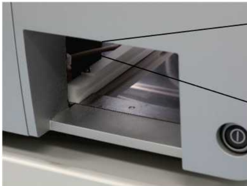
Убран контейнер для отходов.
