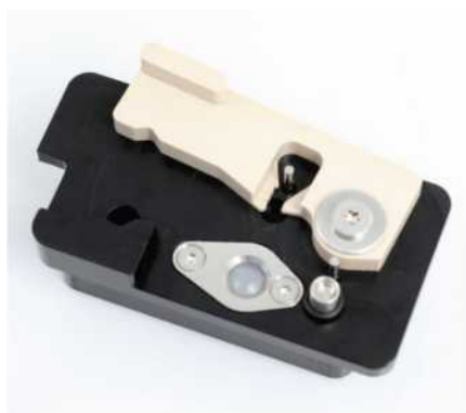
Инструмент для уплотнительных колец с подготовленным новым уплотнительным кольцом.
