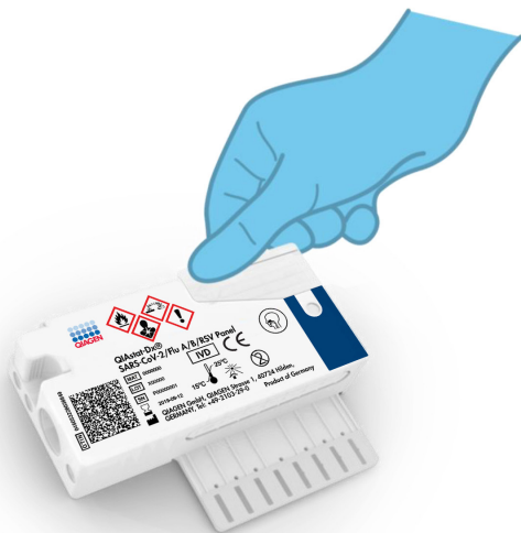
Joonis 22. Põhipordi proovi kaane sulgemine.
