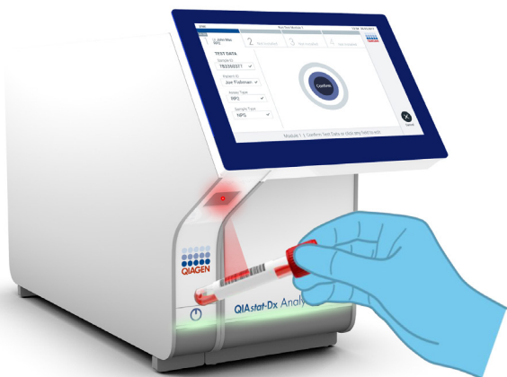
Joonis 11. Proovi ID vöötkoodi skannimine.
