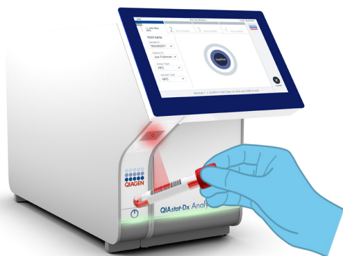
Joonis 24. Proovi ID vöökoodi skannimine.
