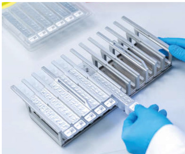
Figur 3. Reagenskassetstativ. Selve kassetstativet merkes med en pil for å angi retningen som reagenskassetter (RCB) må lastes inn i.
