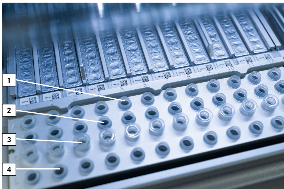
Figur 5. Arbeidsbord på et EZ2 Connect MDx-instrument. (1) Prøverør (ST) (2 ml) lastet inn i rad A. (2) Tom eller valgfritt: Rør (2 ml) som inneholder 80 % etanol for valgfritt vasketrinn, lastet inn i rad B. (3) Engangsspissholdere (DTH) som inneholder engangsfilterspisser (DFT) lastet inn i rad C. (4) Elusjonsrør (ET) (1,5 ml) lastet inn i rad D.
