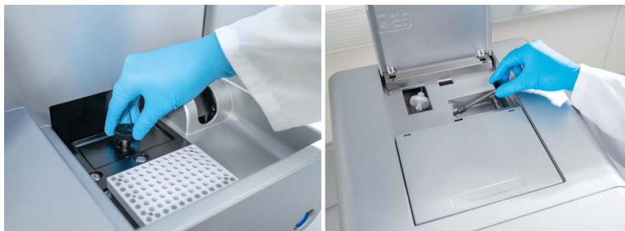
Figura 3. Scoaterea dispozitivului de blocare pentru transport.
