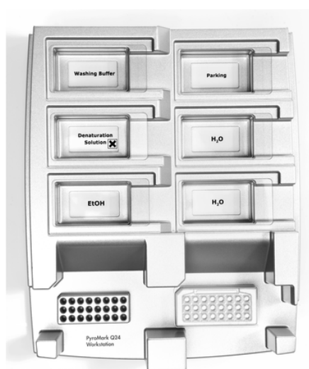
Rysunek 2. Umieszczanie płytki PCR (lub pasków) oraz płytki PyroMark Q24 na stacji próżniowej
