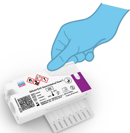
Afbeelding 8. Het deksel van de hoofdopening sluiten.
