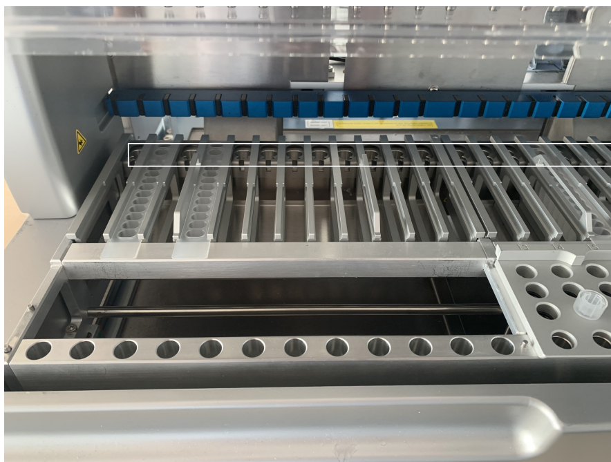
Ryc. 17. Pozycje statywu na kasety, które można ogrzać (zaznaczone białą ramką).
