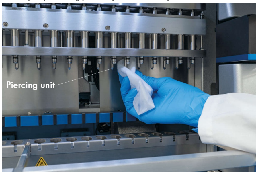
Ryc. 174. Czyszczenie zespołu perforującego aparatu EZ2.
