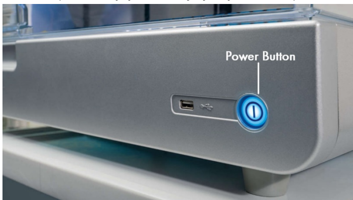
Ryc. 23. Lokalizacja przycisku zasilania.
