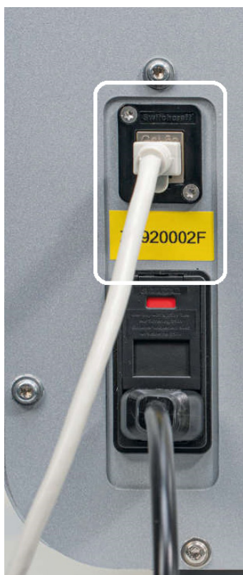
Ryc. 6. Lokalizacja portu RJ-45 (zaznaczona białą ramką).
