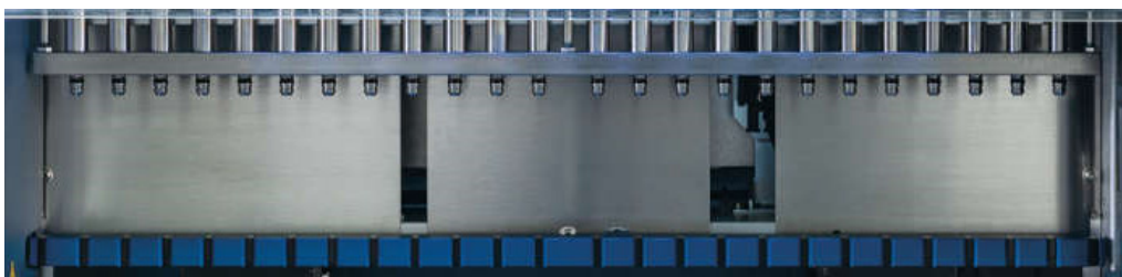
Ryc. 10. Głowica pipetora aparatu EZ2.
