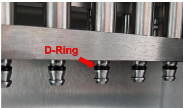
Ryc. 177. Adapter końcówki z oznaczonym D-ringiem.
