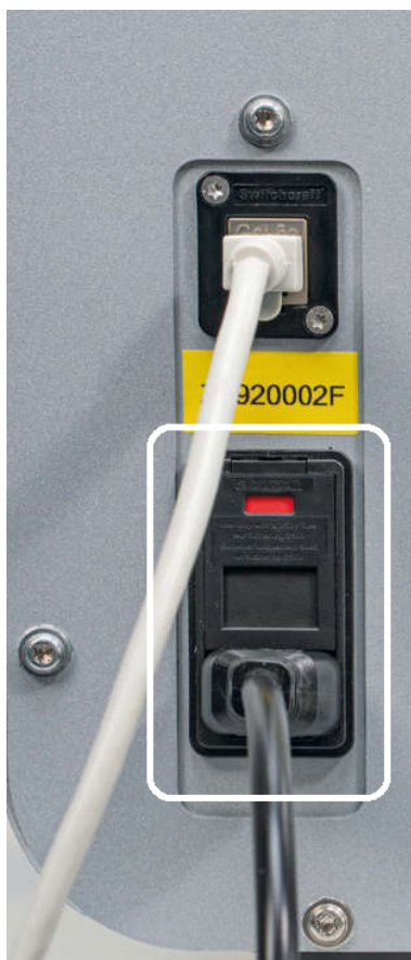
Ryc. 7. Lokalizacja gniazda dla przewodu zasilającego (zaznaczona białą ramką).
