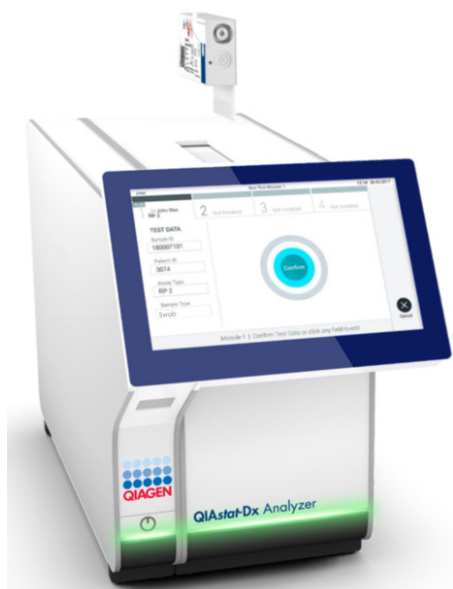
Slika 15. Ubacivanje kertridža QIAstat-Dx Respiratory SARS-CoV-2 Panel Cartridge u analizator QIAstat-Dx Analyzer 1.0 ili QIAstat-Dx Analyzer 2.0.
