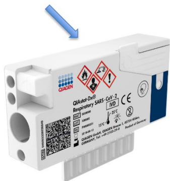
Slika 38. Postavljanje informacija o uzorku na gornju stranu kertridža QIAstat-Dx Respiratory SARS-CoV-2 Panel Cartridge.
