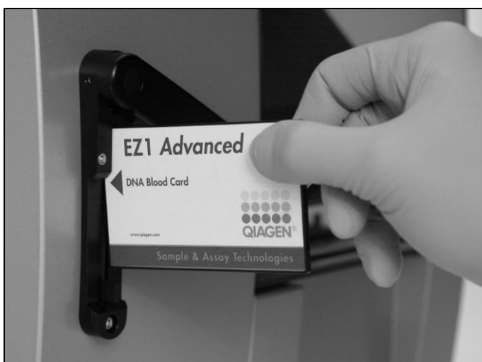
Εικόνα 9. Εύκολη εγκατάσταση πρωτοκόλλου με τη χρήση Καρτών EZ1 DSP. Τοποθέτηση μιας Κάρτας EZ1 που περιέχει το πρωτόκολλο, στο όργανο EZ1.
