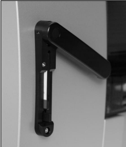
Εικόνα 10. Κάρτα EZ1 Card πλήρως τοποθετημένη εντός της υποδοχής της Κάρτας EZ1.
