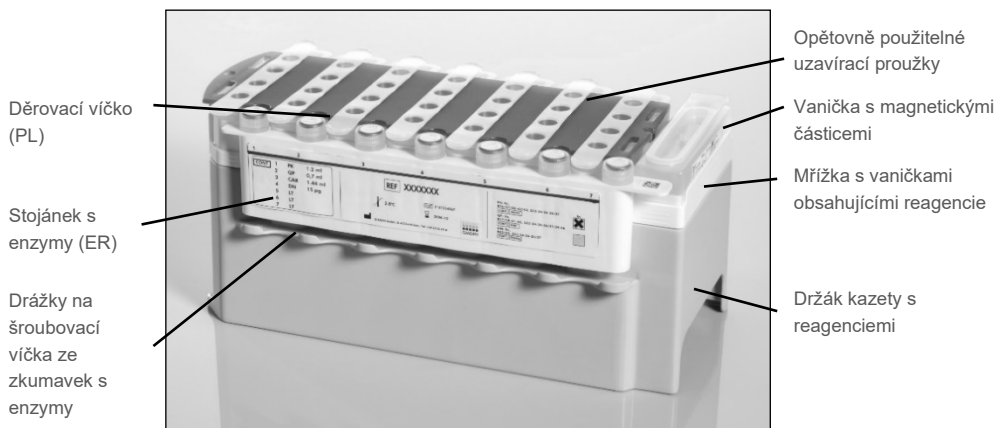
Obrázek 2. Kazeta s reagenziemi (RC) QIASymphony. Kazeta s reagenziemi (RC) obsahuje všechny reagenzie potřebné na zpracování protokolu.
