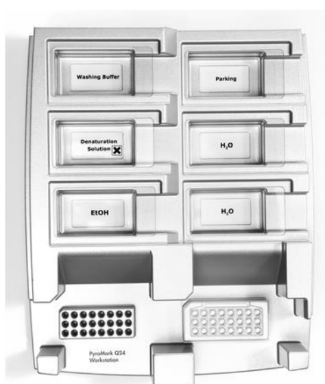
Figur 2. Placering af PCR-plade (eller strips) og PyroMark Q24-plade på vakuumarbejdsstationen.
