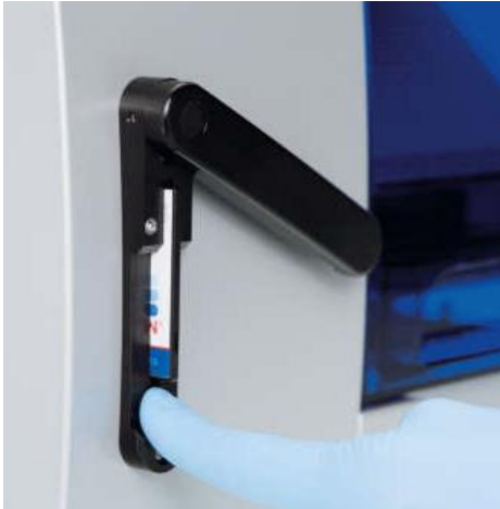
Abbildung 7. Karte vollständig in den EZ1 Card Steckplatz eingeschoben.
