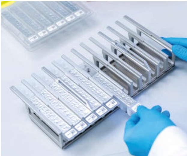
Abbildung 3. Reagenzienkartuschenrack. Das Kartuschenrack selbst ist mit einem Pfeil versehen, der anzeigt, in welcher Richtung die Reagenzienkartuschen (RCV) geladen werden müssen.
