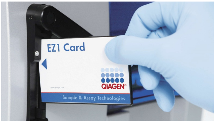
Abbildung 6. Einfache Protokolleinrichtung mithilfe von EZ1 DSP Cards. Einsetzen einer EZ1 Card, auf der das Protokoll vorprogrammiert ist, in das EZ1 Gerät.
