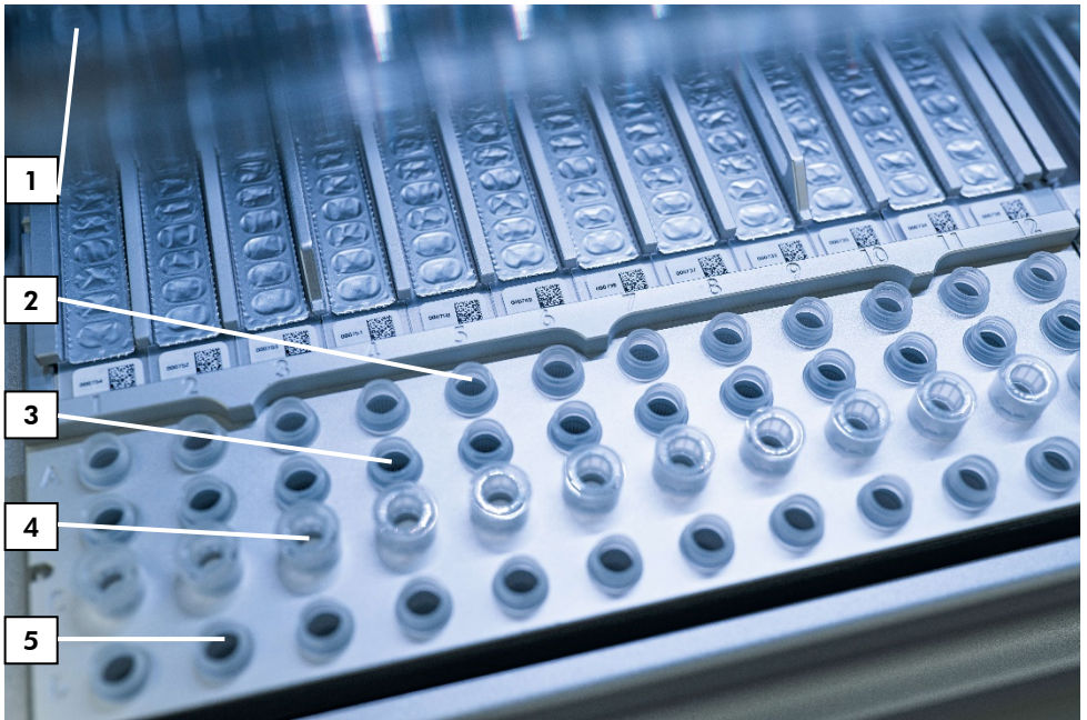
Abbildung 5. Arbeitsplattform eines EZ2 Connect MDx Geräts. (1) Heizblock mit 2-ml-Röhren (ST), geladen in die Reagenzienkartuschen (RCV) zur Lyse. (2) Probenröhren (ST) (2 ml), geladen in Reihe A. (3) Röhren (ET) (1,5 ml) mit Carrier-RNA (CARRIER) und (falls verwendet) interner Kontrolle (Internal Control, IC) in Elutionspuffer (AVE), geladen in Reihe B. (4) Halter für Einmal-Pipettenspitzen (DTH) mit Einmal-Filterpipettenspitzen (DFT), geladen in Reihe C. (5) Elutionsröhren (ET) (1,5 ml), geladen in Reihe D.
