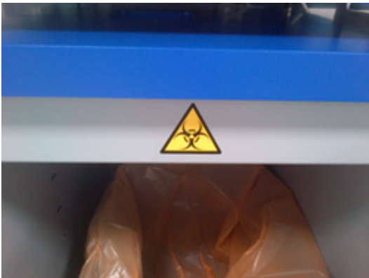
* Posizione dell'etichetta di avvertenza di rischio biologico sul pannello del cabinet (SP).
