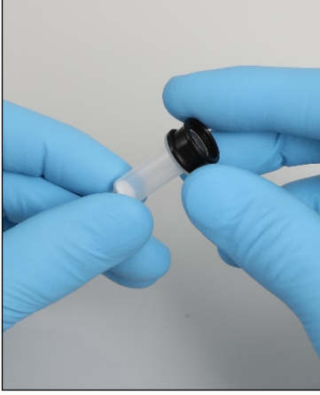
Döndürme kolonu adaptör halkasını takma.
