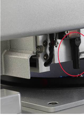
Ultrasonik sensörün siyah ışın kolimatörü (kırmızı daireye bakın).
