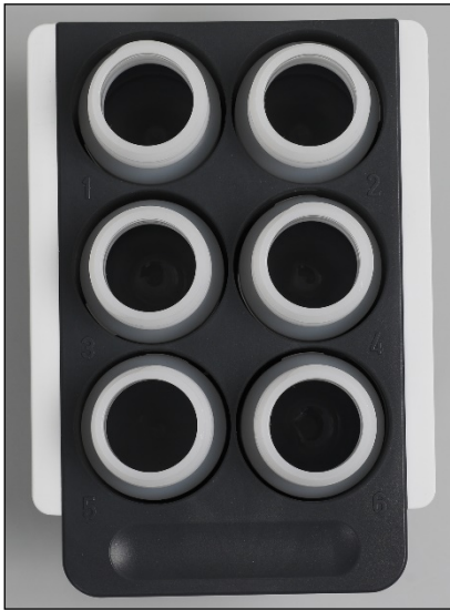
Yan taraflarda etiketleme şeritleri takılı reaktif şişesi rafı.
