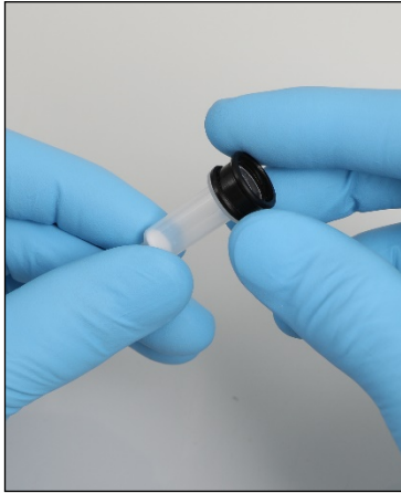
Pyörityskolonnin adapterirenkaan asentaminen.
