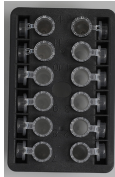
Näyteputkien korkit on asetettava tukevasti ravistintelineen reunassa oleviin koloihin.
