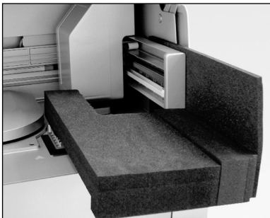
Vaahtomuovisuojus asetettuna sentrifugin ja robottivarren väliin.
