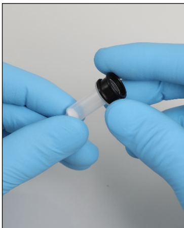
Montaje de un anillo adaptador para columnas de centrifugación.
