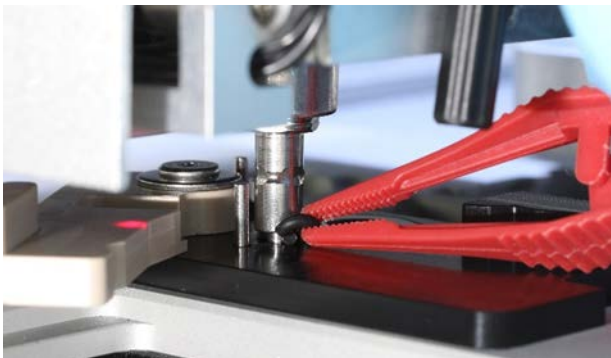
Abra la palanca gris y retire la junta tórica con las pinzas
