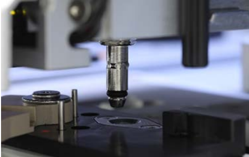
Compruebe si la nueva junta tórica se asienta con firmeza
