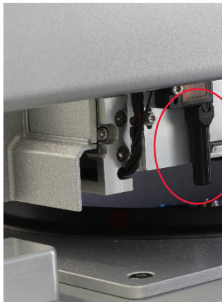
Colimador de haz negro (círculo rojo) del sensor ultrasónico
