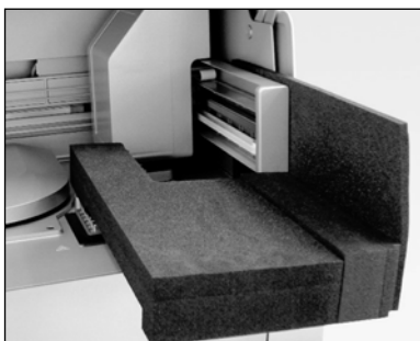
Protector de espuma para el brazo robótico.
