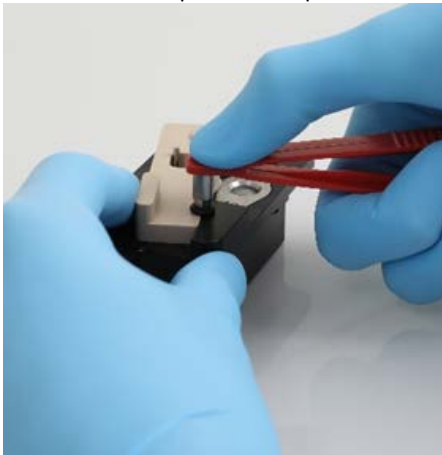
Presione la clavija hacia abajo con el extremo posterior de las pinzas
