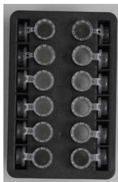
Las tapas de los tubos de muestras se deben colocar firmemente en las ranuras situadas en el borde de la gradilla del agitador
