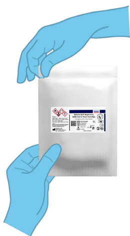
Obrázok 5. Otvorenie kazety QIAstat-Dx Respiratory SARS-CoV-2 Panel Cartridge.
