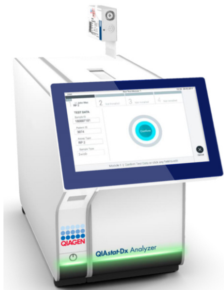
Obrázok 15. Vloženie kazety QIAstat-Dx Respiratory SARS-CoV-2 Panel Cartridge do analyzátoru QIAstat-Dx Analyzer 1.0 alebo QIAstat-Dx Analyzer 2.0.
