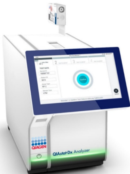
Obrázok 48. Vloženie kazety QIAstat-Dx Respiratory SARS-CoV-2 Panel Cartridge do analyzátoru QIAstat-Dx Analyzer 1.0 alebo QIAstat-Dx Analyzer 2.0.
