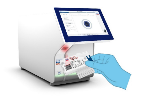
Figura 45. Lendo o código de barras do QIAstat-Dx Respiratory SARS-CoV-2 Panel Cartridge.
