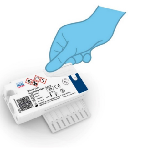
Figura 42. Fechando a tampa de amostra da porta principal.
