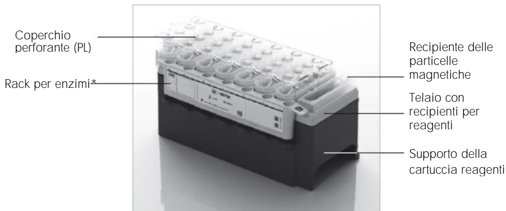
Figura 2. Cartuccia reagenti (RC) QIASymphony. La cartuccia reagenti (RC) contiene tutti i reagenti necessari per l'esecuzione del protocollo. *Il QIASymphony DSP HPV Media Kit non include né richiede un rack per enzimi.
