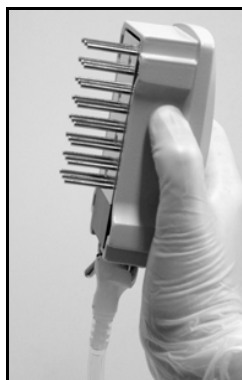
Figure 4. Outil à vide levé au-delà de la verticale
